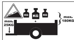
При использовании прицепа превышение следующих максимальных параметров запрещено:
