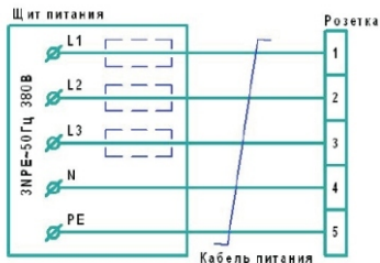
Рис. 3 Схема подключения розетки к стационарной сети
