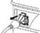
2. Поверните топливный кран в положение «ON»
