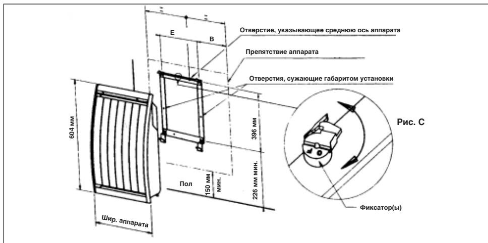
Чтобы облегчить установку с минимальным расстоянием 150 мм (между низом аппарата и полом), достаточно поместить кронштейн напротив стены, нижние ножки установить на пол, и при помощи соответствующих отверстий отметить габариты аппарата.
